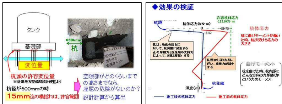
※ 発表資料の一部 (タンク及び配管ラック基礎部分地盤沈下対応)
