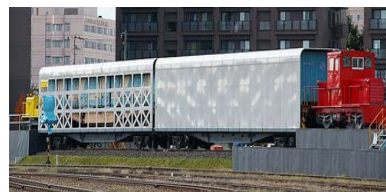
【「トレイン・オン・トレイン」の実験車両に入った貨物列車】
